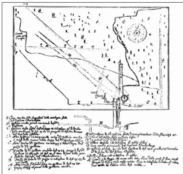
Fig. 1 - Disegno del Capitano Mühlhan relativo alla miniera «Vittorio Amedeo» di Sagliano (1728). La ruota idraulica, di m. 6,18 di diametro, si trovava in sotterraneo ad oltre 100 m. dall’imbocco. (Archivio di Stato di Torino, Sezioni Riunite, Masso I - Miniere)
